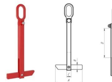
Захват предназначен для подъёма и перемещения бетонных плит перекрытия. Конструкция захвата относится к коромысловому типу. Груз фиксируется за счет поворота коромысла. Удобен при перемещении плит без проушин. Для подъёма необходимо использовать не менее 4-х захватов с подвесом на стропе 4СК (4СЦ) или траверсе.
