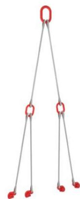
Предназначен для подъёма и перемещения двух труб одновременно. В состав комплекта входит 3 двухветвевых стропа. Стропы могут выполняться в различных исполнениях: канатные, круглопрядные, цепные. Концевые элементы на двухветвевых стропах — торцевые захваты типа ЗЗСК(1,2,3).
