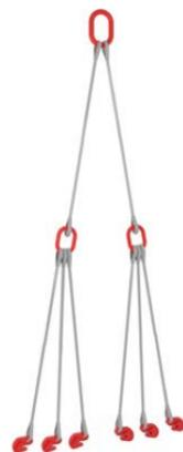
Предназначен для подъёма и перемещения 3-х труб одновременно. В состав комплекта входит: 1 двухветвевой и 2 трехветвевых стропа. Стропы могут выполняться в различных исполнениях: канатные, круглопрядные, цепные. Концевые элементы на трехветвевых стропах — торцевые захваты типа ЗЗСК(1,2,3).
