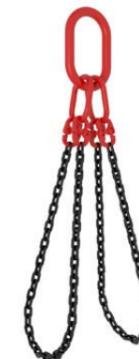
Данный строп представляет собой две замкнутые в кольцо цепные ветви на одном верхнем концевом элементе — звене. Применяется в основном для подъёма грузов, укрепленных на поддонах (поддоны с кирпичом, поддоны с металлом в слитках, и т. д.). Также может применяться для подъёма при методе строповки грузов в обхват, геометрические размеры которых диктуют необходимость двух точек крепления стропа.
