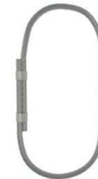
Представляет собой замкнутый кольцевой отрезок каната. Применяется, как правило, для обвязки грузов «на удавку», а также для строповки крупногабаритных конструкций, не имеющих проушин в местах крепления.
