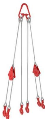
Стропы с уравнительными блоками используются для подъёма и перемещения грузов со смещённым центром тяжести и при несимметричном расположении монтажных петель. Используемые в стропах блоки равномерно распределяют нагрузку между всеми ветвями стропа, с их помощью также можно расконтровать груз из вертикального положения в горизонтальное и наоборот.
